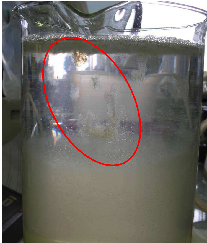
Fig. 3.26 - Azione del flocculante sul microcosmo estivo. Segnate in rosso si notano le particelle in fase di aggregazione
