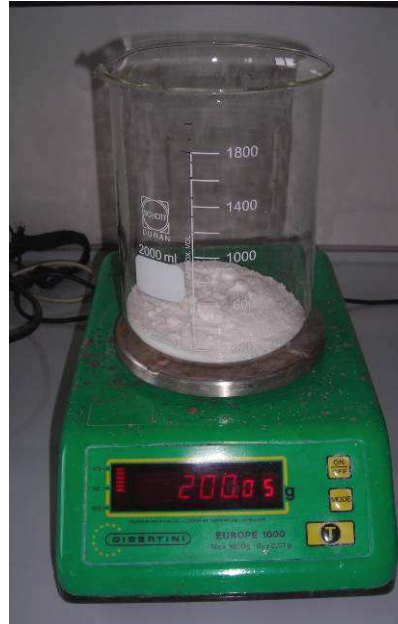
Fig. 3.5 - Fase 1 – Calcolare la quantità di sale necessaria e pesarla su bilancia analitica. In foto: Pesata del sale (NaCl)
