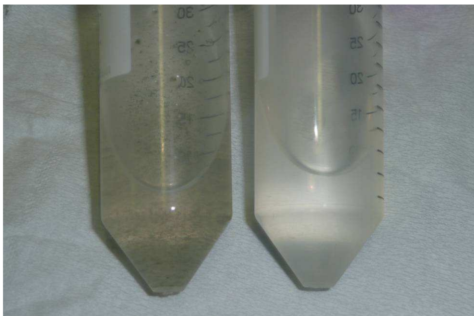
Fig. 3.27 - Riduzione della torbidità nello strato NCZ in seguito al trattamento sperimentale 0,13% nel campione invernale
