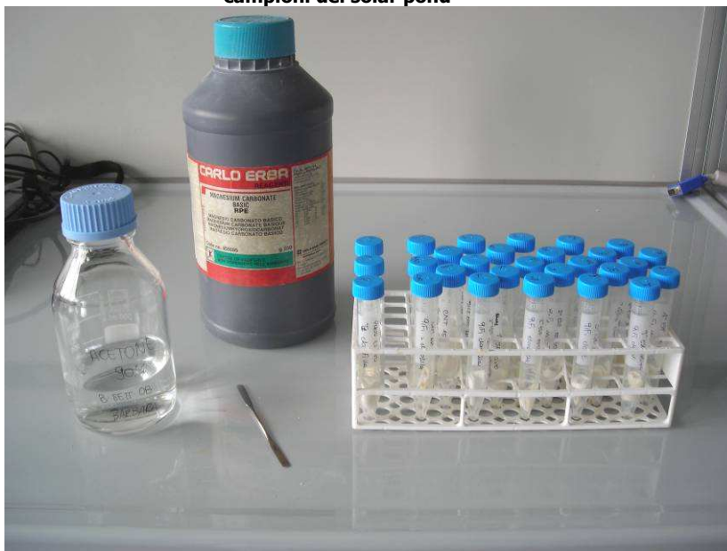
Fig. 3.14 - Allestimento del materiale necessario per l'analisi del contenuto in pigmenti fotosintetici nei campioni del solar pond
