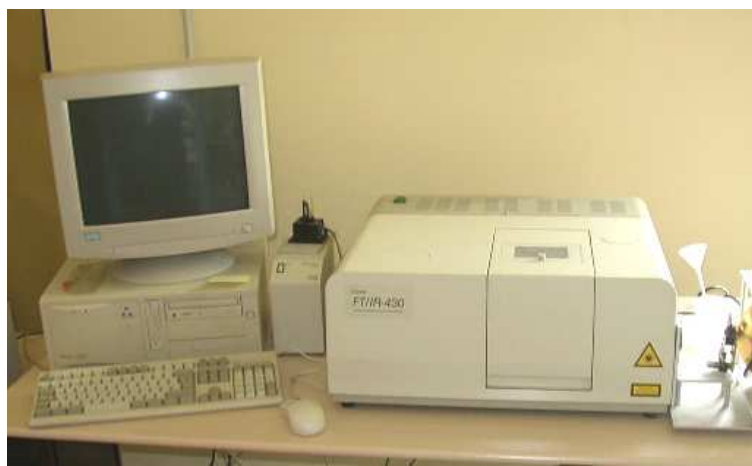
Fig. 3.12 - Spettrofotometro Jasco utilizzato per l'analisi della torbidità
