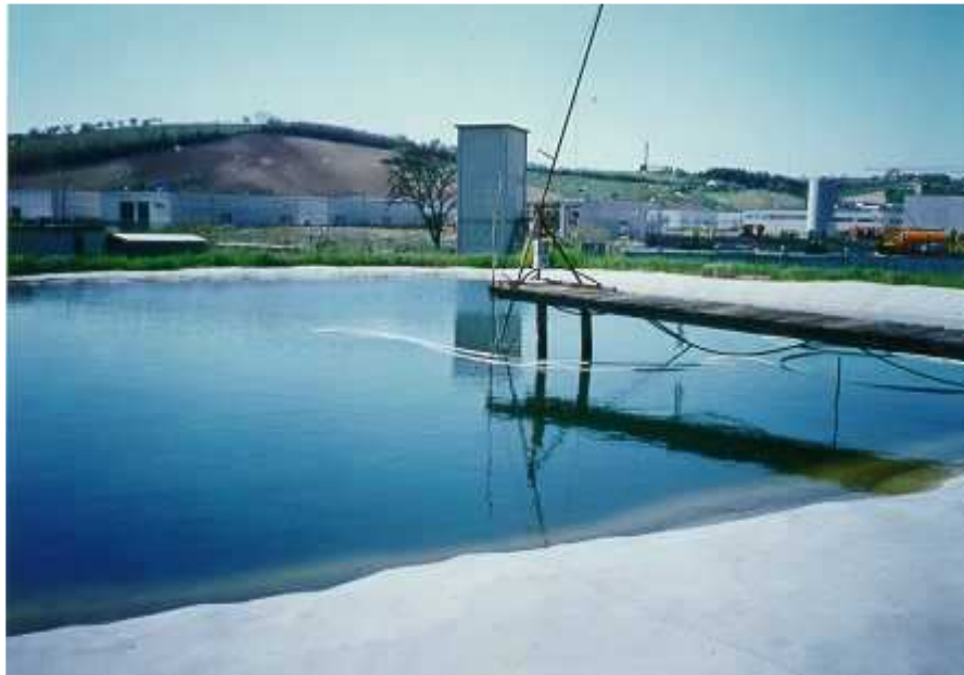
Fig. 3.1 - Solar pond sperimentale di Ancona nel mese di Aprile (situazione invernale)
