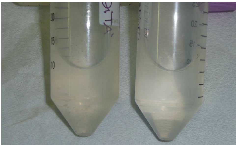
Fig. 3.28 - Riduzione della torbidità nello strato NCZ in seguito al trattamento sperimentale 0,26% nel campione estivo
