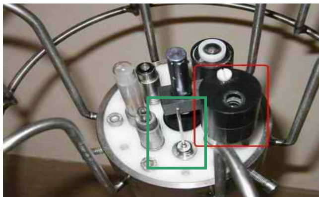
Fig. 4.4 - Particolare di una sonda utilizzata per la misura di salinità e temperatura. In rosso è indicato il sensore della conducibilità elettrica (salinità), mentre in verde quello della temperatura
